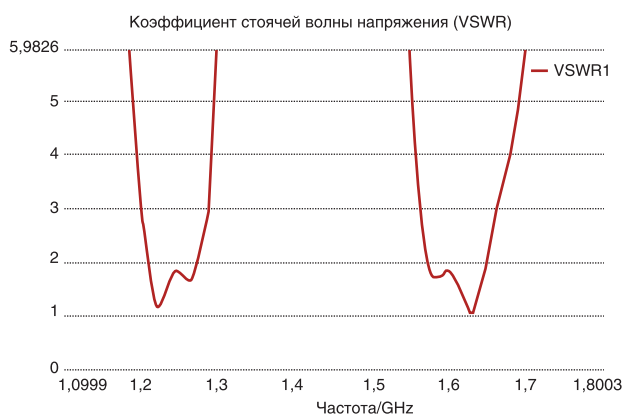
Рис. 3. КСВН элемента антенной решетки
