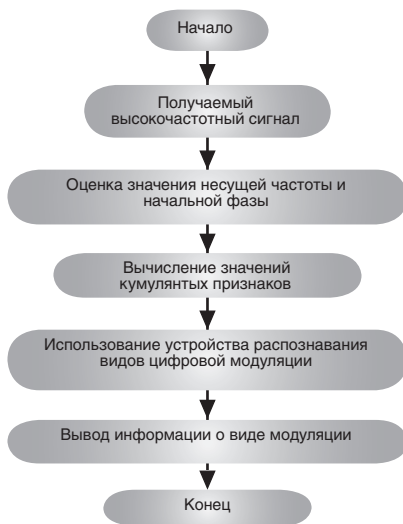
Рис. 5. Блок-схема алгоритма определения видов цифровой модуляции при неизвестном значении несущей частоты
