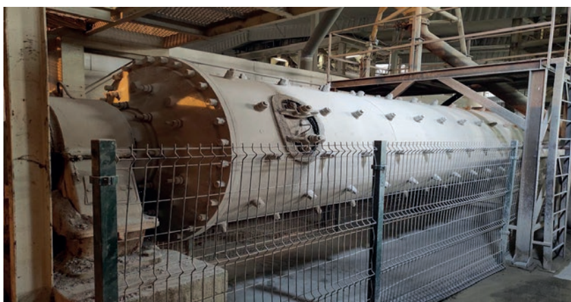
Рис. 2. Оперативно модернизированная для производства наноцементов сухим помолом мельница СМ 1456 (ООО «Техносервис», пос. Луговое Калининградской области)
