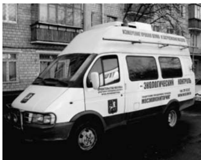
Рис. 6. Передвижная станция контроля загрязнений атмосферного воздуха и воздуха рабочей зоны ПСКЗА на базе автомобиля «Газель» фирмы ОАО «Прима-М
