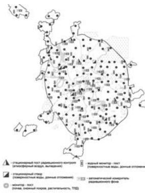
РИС. 4. Система радиоэкологического мониторинга ГУП МосНПО «Радон»
